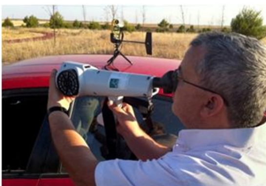
Figura 3. Mediciones meteorológicas y olfatométricas simultáneas
